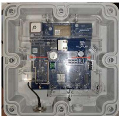
3. Извлечь прозрачную пластиковую накладку, разжав зажимы.
