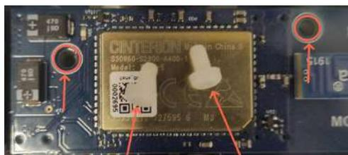
4. Открутить против часовой стрелки два пластиковых винта на модуле GSM (плоской или крестовой отверткой 3 мм), аккуратно извлечь.
