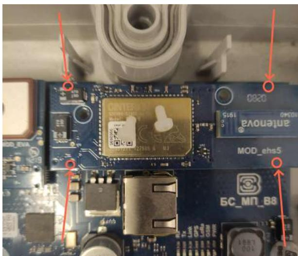
5. Извлечь модуль GSM, взяв двумя руками с двух сторон согласно стрелкам
