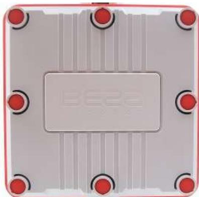
2. Открыть крышку базовой станции. Для этого необходимо предварительно снять резиновые заглушки и открутить восемь винтов крепления крышки (винты необходимо оставить в корпусе крышки).
