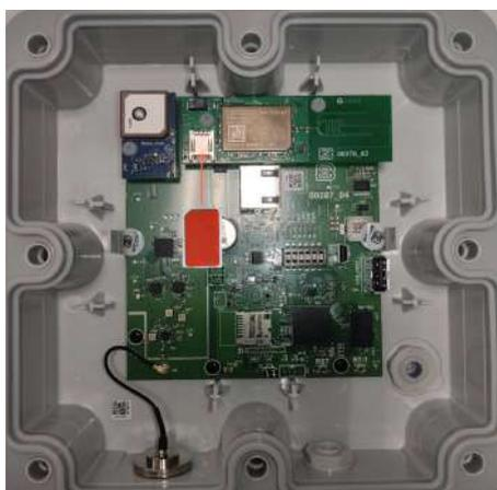
7. Произвести установку модуля GSM, фиксирующих пластиковых винтов, прозрачной пластиковой наклейки, разъема питания 12-48 В в обратном порядке.
