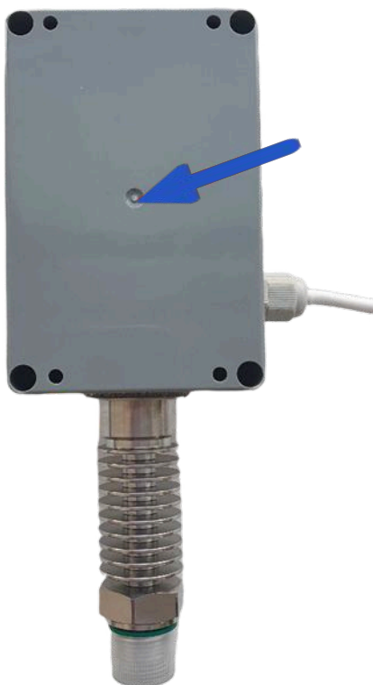
Рисунок 3 - Место поднесения магнита для активации Устройства
